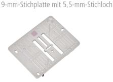
Diese Stichplatte hat eine violette Markierung und eine verkleinerte Stichlochbreite von 5,5 mm. Sie passt auf alle 9-mm-Maschinen und erzielt besonders gute Nähergebnisse beim Nähen von dünnen oder weichen Stoffen. Für detailreiche Näharbeiten können alle Zickzack- und Dekorstiche bis maximal 5,5 mm angewendet werden.
