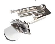
Der Bandeinfasser dient zum Einfassen von Kanten mit vorgefalztem Schrägband in einer Breite von 13, 20 oder 25 mm. Mit ihm gelingen perfekte Ecken und wunderschöne Rundungen, die mit einem Nutz- oder Dekorstich verarbeitet werden. Bänder von 13, 20 und 25 mm Breite ergeben eine fertige Breite von ca. 6, 9,5 und 12 mm.
