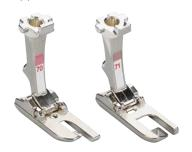
Mit ihm lassen sich exakte Kappnähte anfertigen. Da beide Nahtzugaben in die Saumnaht eingeschlossen und festgesteppt werden, eignen sie sich auch für beidseitig tragbare Bekleidung. Der Fuss #70 ist für Kappnähte bis 3 mm Breite und der Fuss #71 für Kappnähte bis 6 mm Breite geeignet.
