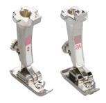
Der Overlockfuss ist bestens geeignet zum Anfertigen von Overlocknähten und Versäubern von Kanten in elastischem Material aber auch Webware. Die Stoffkanten rollen nicht ein, und es entsteht eine flache elastische Naht.
