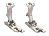
Dieser Nähfuss ist ideal zum Säumen von weichen Stoffen wie Tricot oder ähnlichen Materialien. Der Stoff wird beim Nähen in einem Arbeitsgang doppelt umgeschlagen und mit einem Overlockstich festgenäht. Dadurch bildet sich ein schmaler, leicht dreidimensionaler Saum, der nicht ausfranst. Die Füsse #68 und #69 werden für Säume mit 2 bzw. 4 mm Breite angewendet.
