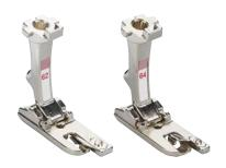
In Verwendung mit der Geradstichplatte bildet der Geradstichsäumer einen feinen Saum und sorgt für ein besonders schönes Stichergebnis. Der Stoff wird beim Nähen in einem Arbeitsgang doppelt umgeschlagen und mit einem Geradstich festgenäht. Die Füsse #62 und #64 werden für Säume mit einer Breite von 2 bzw. 4 mm eingesetzt.
