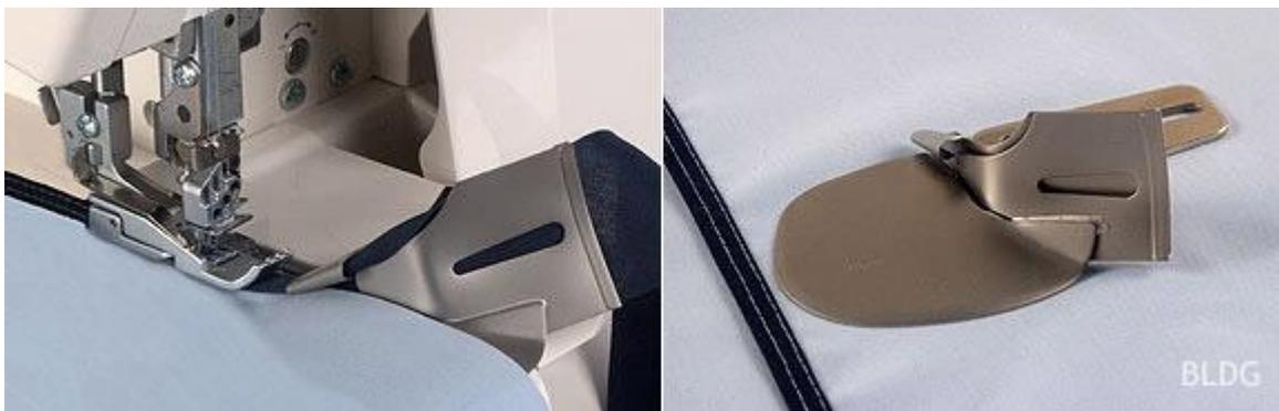
Der Doppelfaltschrägbinder macht es möglich, Stoffkanten oder Halsausschnitte mit Cover- oder Doppelkettstich sehr schnell und sehr exakt mit Schrägband einzufassen, wobei die Ober- und Unterseite des Schrägbandes doppelt umgeschlagen werden.
