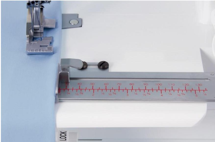
Diese Führung ermöglicht dank der verstellbaren Kante das präzise Anlegen der Säume/Umschläge und somit den korrekten Nahtabstand.
