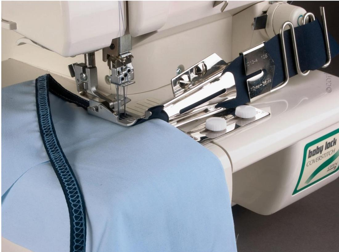
Der Doppelfaltschrägbinder macht es möglich, Stoffkanten oder Halsausschnitte mit Cover- oder Doppelkettstich sehr schnell und sehr exakt mit Schrägband einzufassen, wobei die Ober- und Unterseite des Schrägbandes doppelt umgeschlagen werden. Mit Hilfe des Führungsrechen wird das Schrägband perfekt und einfach in den Doppelfaltschrägbinder geführt.
