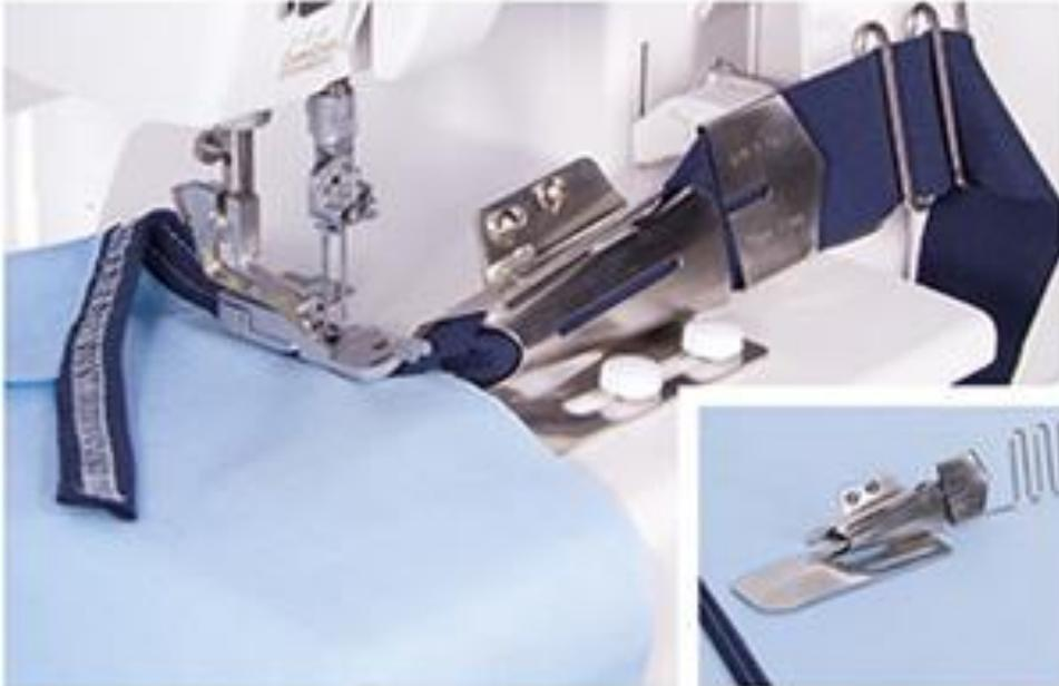
Der Einzelfaltschrägbinder ermöglicht ein professionelles Einfassen von offenen Stoffkanten (z. B. Halsausschnitte) mit Cover- oder Doppelkettstich. Schräg- bzw. Jerseystreifen werden durch die Faltvorrichtung so geführt, dass die Oberseite doppelt eingeschlagen wird. Die Unterseite liegt glatt und offen innen am Stoffrand.
