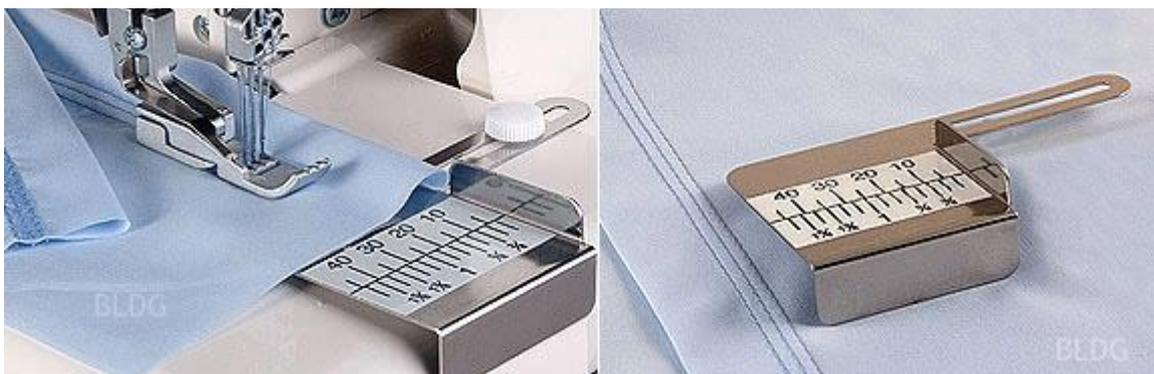
Diese Führung ermöglicht dank der verstellbaren Kante das präzise Anlegen der Säume/Umschläge und somit den korrekten Nahtabstand.
