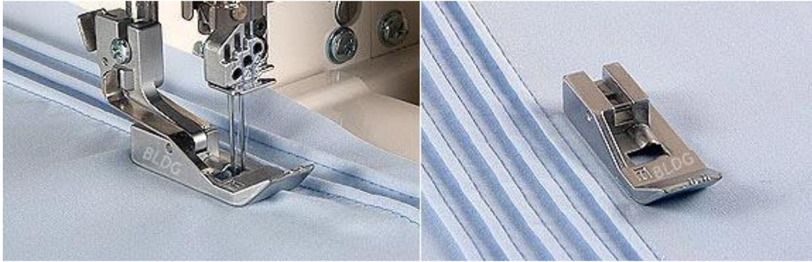
Mit dem Biesenfuß und der dazugehörigen Biesenzunge können Biesen und Fältchen einfach und perfekt mit dem Coverstich genäht werden. Der Einsatz der Kederführung ermöglicht das Einlaufen einer Kederschnur zur Stabilisierung und plastischen Darstellung der Biesen.
