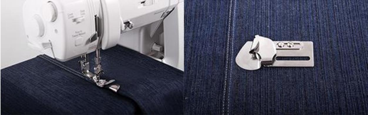
Die Kappnaht ist eine Nahtvariante, bei der die Stoffkanten gegenläufig umschlagen werden, so dass am Ende beide Schnittkanten innerhalb des Gewebes liegen. Sie wird oft bei der Verarbeitung von Jeans bzw. derben Stoffen, wie Canvas, Segeltuch eingesetzt.
