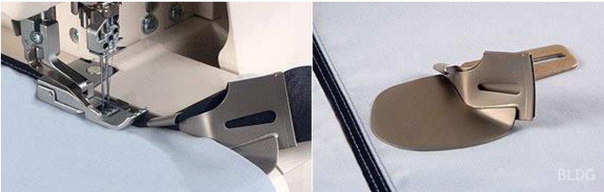
Der Einzelfaltschrägbinder macht es möglich, Stoffkanten oder Halsauschnitte mit Cover- oder Doppelkettstich sehr schnell und sehr exakt mit Schrägband einzufassen, wobei die Oberseite doppelt umgeschlagen wird und die Unterseite offen bleibt.
