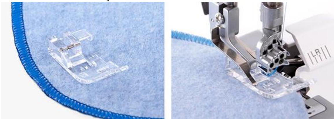
Der transparente Kurvenfuß ist ideal für gekrümmte Nähte und erlaubt eine bessere Sicht auf das Nähprojekt. Er ermöglicht ein müheloses Übernähen von Quernähten. Enge Ärmelbündchen und Halsausschnitte lassen sich bequemer Versäubern. Durch den Führungsschlitz können Bänder mit gefasst werden.
