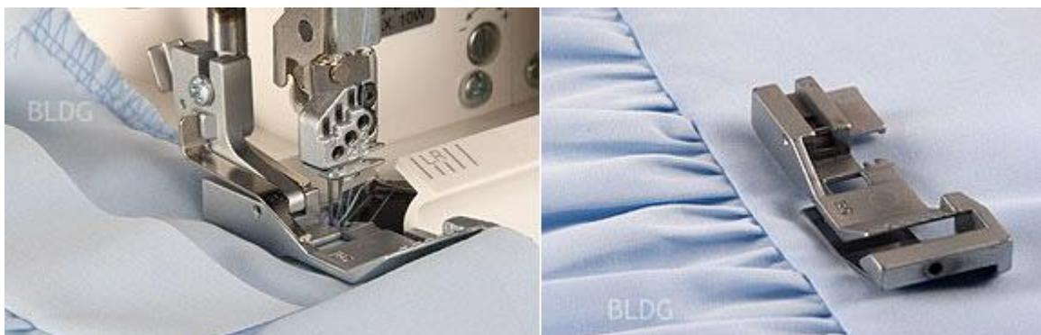
Der Kräuselfuß ist für das Zusammennähen zweier Stofflagen, wobei die untere Stofflage im Verhältniss 2:1 gekräuselt wird. Eine Erhöhung des Differentialtransportes und der Stichlänge bewirkt einen noch stärkeren Kräuseleffekt.
