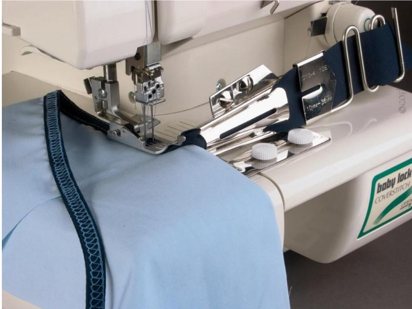
Der Doppelfaltschrägbinder macht es möglich, Stoffkanten oder Halsausschnitte mit Cover- oder Doppelkettstich sehr schnell und sehr exakt mit Schrägband einzufassen, wobei die Ober- und Unterseite des Schrägbandes doppelt umgeschlagen werden. Verfügbare Grössen:
