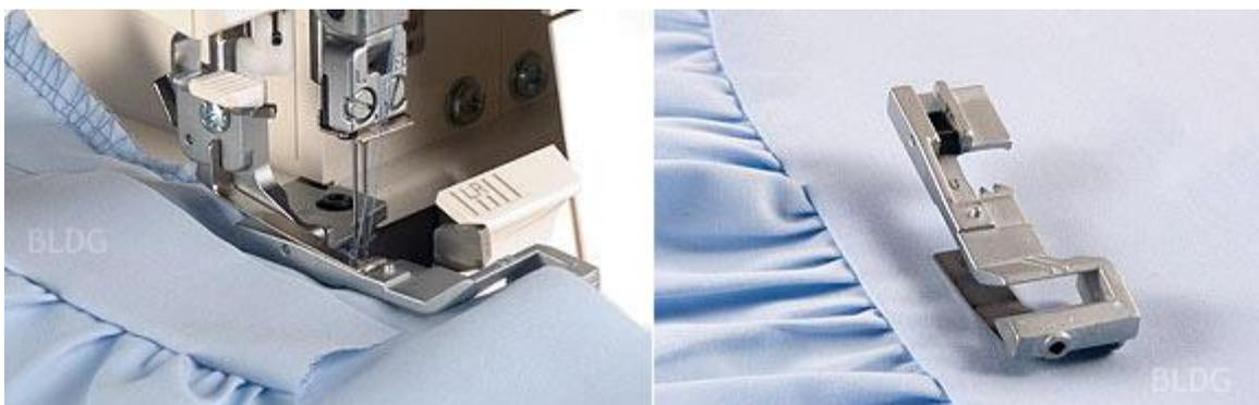
Der Kräuselfuß ist für das Zusammennähen zweier Stofflagen, wobei die untere Stofflage im Verhältniss 2:1 gekräuselt wird. Eine Erhöhung des Differentialtransportes und der Stichelänge bewirkt einen noch stärkeren Kräuseleffekt.
