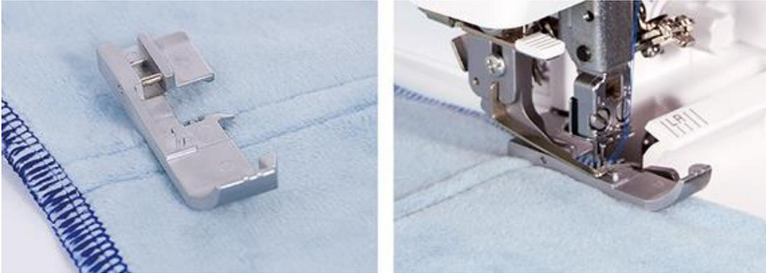
Mit dem Flachsohlenfuß gelingt das Übernähen von mehreren Stofflagen (Fleece, Jeans, übereinanderliegende Nähte usw.) leichter. Durch die lange, starre Bauform wird der Füßchendruck gut verteilt und schwierige Stellen lassen sich besser verarbeiten.
