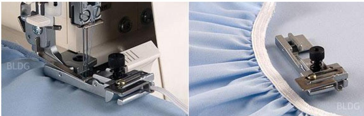
Mit dem Gummibandfuß lassen sich Gummibänder in unterschiedlichsten Breiten und mit gleichmäßiger Dehnung aufnähen. Weiterhin verfügt dieser Fuß über einen speziellen Einlauf, mit dessen Hilfe man problemlos Einlaufgarn oder Angelsehne als Nahtstabilisator verarbeiten kann.
