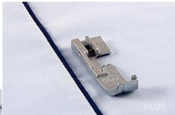
Dieser Fuß verfügt über eine speziell eingearbeitete Führungsnut auf der Fußunterseite. In dieser Nut wird das Paspelband oder der Keder exakt geführt. Man kann somit Paspelband professionell zwischen zwei Stofflagen einnähen oder eine Kederschnur einfassen.
